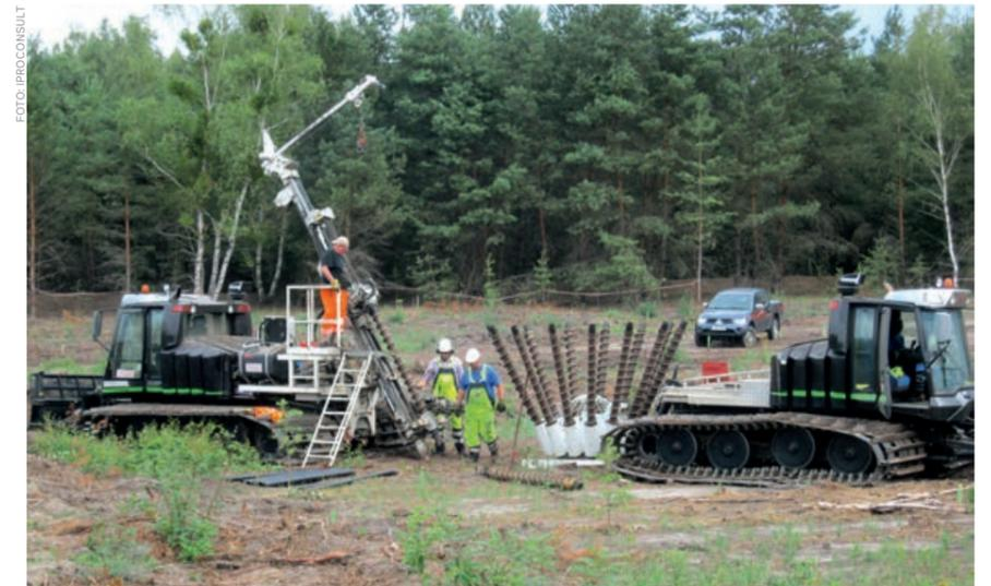
↑ Bis zu 30 Grad Schräge und 35 Meter Tiefe weisen die Bohrungen auf
