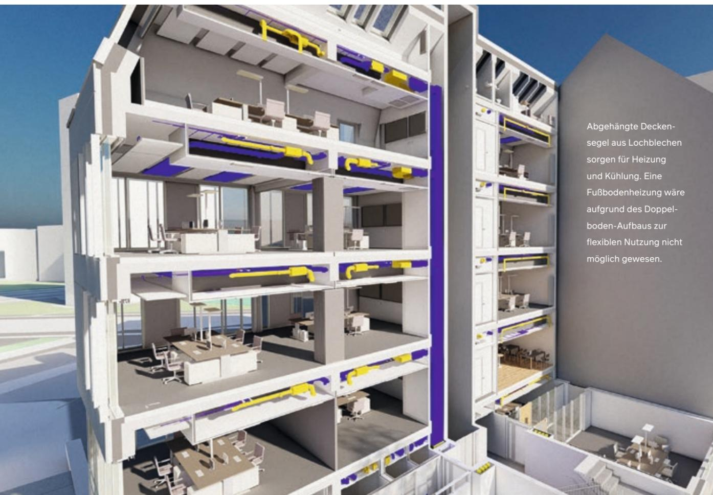
Abgehängte Deckensegel aus Lochblechen sorgen für Heizung und Kühlung. Eine Fußbodenheizung wäre aufgrund des Doppelboden-Aufbaus zur flexiblen Nutzung nicht möglich gewesen.
